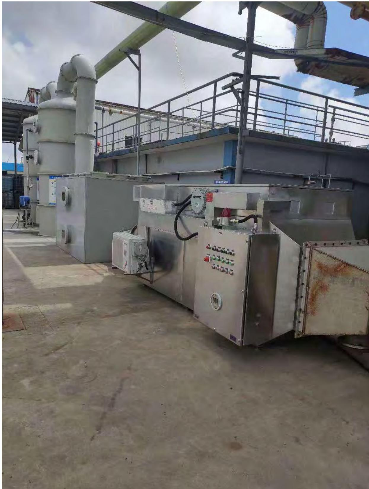
图 4-3-2 废气吸收装置
