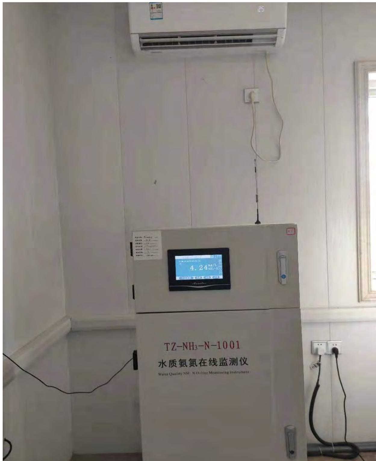
图4-5-1 废水在线监测仪
