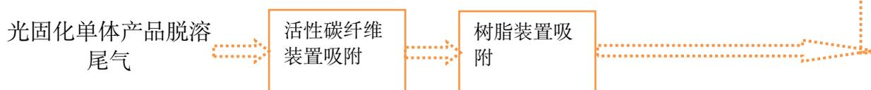
图4-3 光固化单体产品尾气处置流程图
